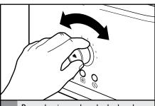
Para seleccionar el grado de dorado que desee, gire el control de intensidad hacia la derecha para dorar más o hacia la izquierda para dorar menos. Para recalentar una tostada que se haya enfriado, gire completamente a la izquierda el control de intensidad.
